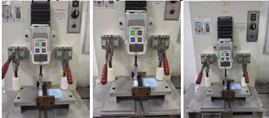
Proses pengujian peel strength sisi belakang secara horizontal
