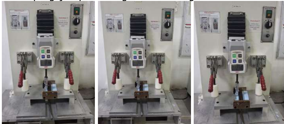
Proses pengujian peel strength sisi belakang secara vertikal
