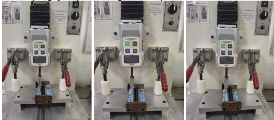
Proses pengujian peel strength sisi depan secara vertikal
