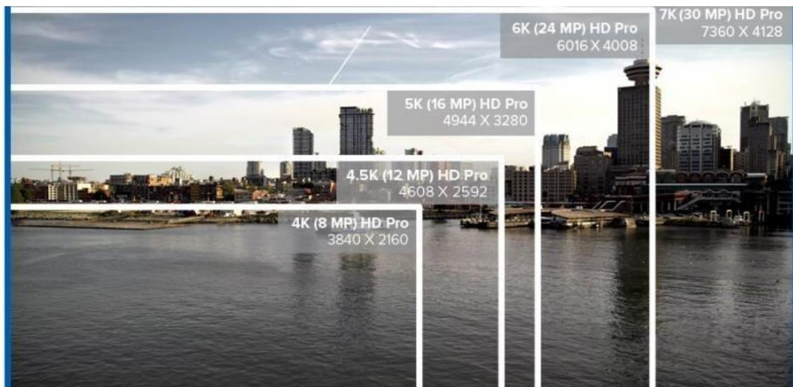
**Gambar 20 Perbandingan Mega Pixel & Keluasan Cakupan Foto pada Kamera CCTV**
