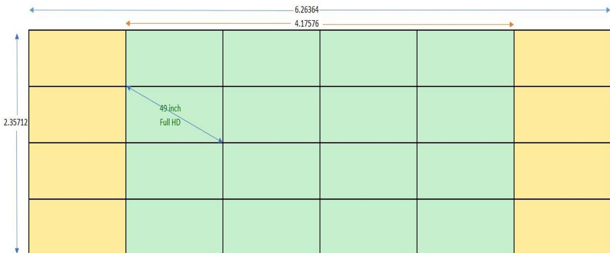
**Gambar 51 Skalabilitas Video Wall Display dari 16 buah menjadi 24 buah**
