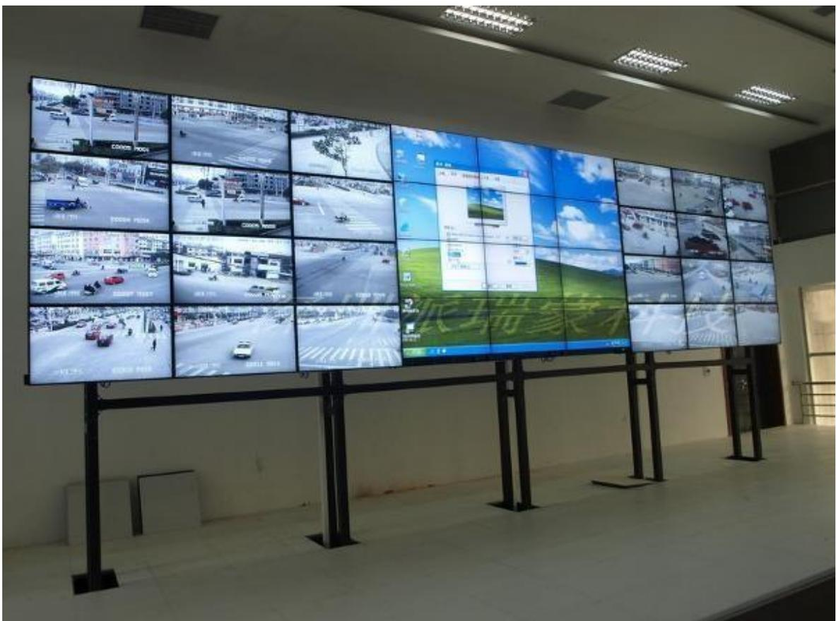
**Gambar 49** *Video Wall Display* yang ditempatkan *standing bracket* dengan pola memanjang
